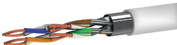
در تکمیل آنچه گفته شد می‌توان در نامگذاری این نوع کابل ها به این نکته نیز اشاره کرد که حروف قبل از علامت (/) نوع شیلد دور کل چهار زوج کابل و حروف بعد از علامت (/) نوع شیلد دور هر زوج کابل را بیان می‌کند، مثلاً در کابل SF/FTP نوع شیلد دور کل کابل شیلد فلزی بافته شده به همراه فویل است و نوع شیلد دور هر زوج از نوع فویل می‌باشد.
